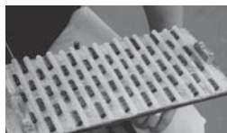
6. 制作用の長さに切り鋼板に載せ加熱
