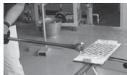
7. 吹き竿の先の溶けたガラスで巻き取る
