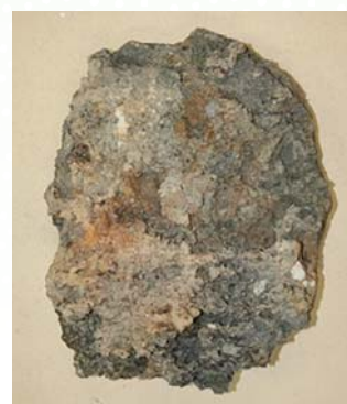
製鉄に失敗して捨てられた鉄塊
