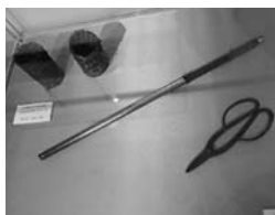
小谷真三ガラス制作道具 上からガラスに溝をつける モール（金型）、吹き竿、ハサミ
