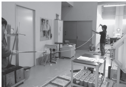
ガラスが柔らかいうちに細く延ばして 模様の元になるガラス棒をつくります。
