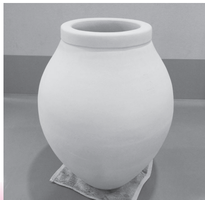
未使用の坩堝。熔解炉に入れる ときは斜めに傾けて設置する。
